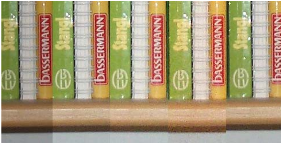
Von links nach Rechts: ISO 50, 100, 200, 400, Auto 1:1-Ausschnitte aus Fotos mit 2304x1728 Pixel, **
